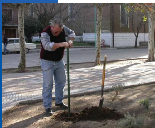
Figura 25. Tareas de perforación con barreno en área urbana para control de nivel freático.
