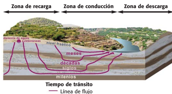
Figura 14. Ejemplos de aumento de tiempos de tránsito del agua subterránea desde las zonas de recarga a las de descarga. Fuente: López Gaeta et al., 2001.
