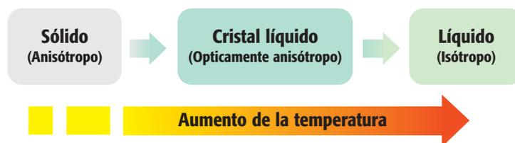
**Figura 13.** Representación de los distintos estados y características por las que atraviesa un sólido del tipo de cristal líquido, con el aumento de la temperatura.
