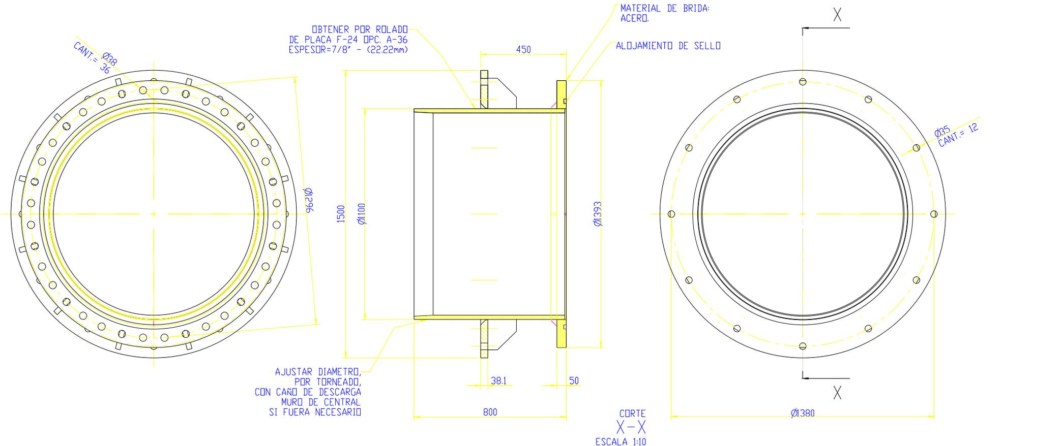
EL ANILLO SE DEJARA FLOTANTE SIN SOLDAR PARA PODER SOLDAR EL TUBO DEL MANGUITO EN EL EXTREMO DEL TUBO DE DESCARGA EXISTENTE Y LUEGO DE FIJAR EL ANILLO AL MURO CON LOS ANCLAJES QUIMICOS, SE SOLDARA EL MISMO AL TUBO, JUNTO CON LAS ESCUADRAS
