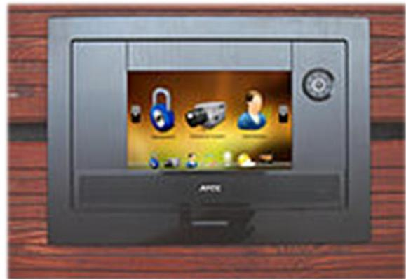
Un panel de control doméstico, capaz de controlar la iluminación, termostato, seguridad, cerraduras y entretenimiento doméstico.
