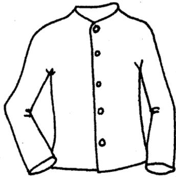
**Casaca:** Su forma puede verse en la figura. Se utiliza para proteger especialmente los brazos y parte del pecho. Su uso es frecuente cuando se realizan soldaduras en posición vertical, horizontal y sobre cabeza.
