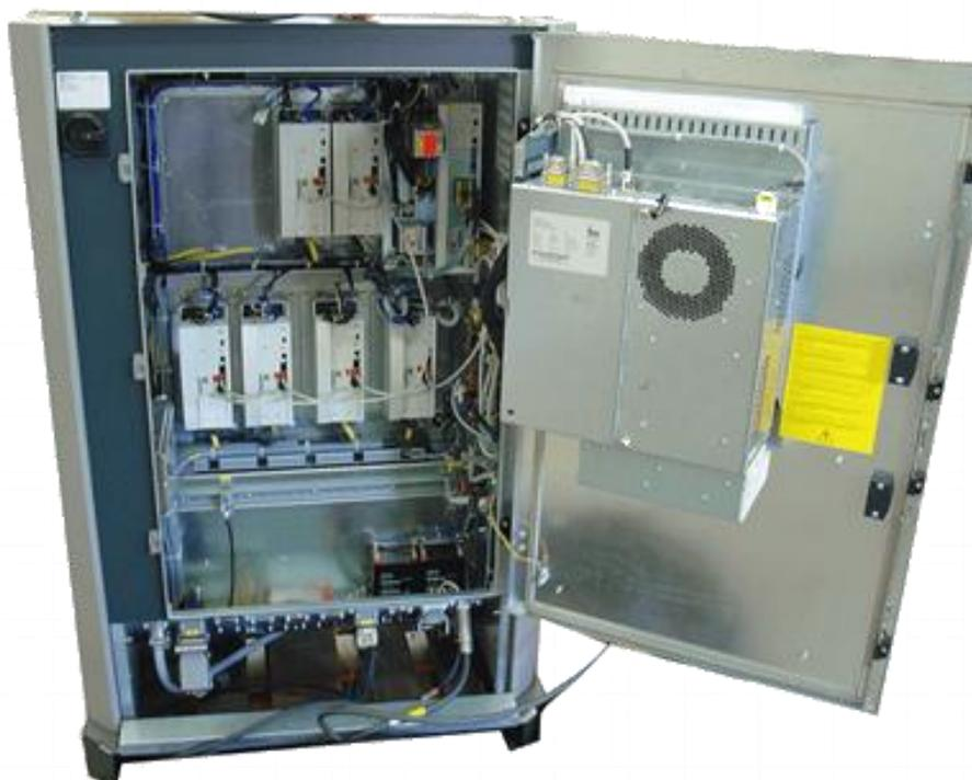
Se pueden utilizar estas tarjetas para comunicar al robot, por ejemplo, con las máquinas de control numérico (torno). Estas tarjetas se componen de relevadores, los cuales mandan señales eléctricas que después son interpretadas en un programa de control. Estas señales nos permiten controlar cuando debe entrar el robot a cargar una pieza a la máquina, cuando deben empezar a funcionar la máquina o el robot, etc.
