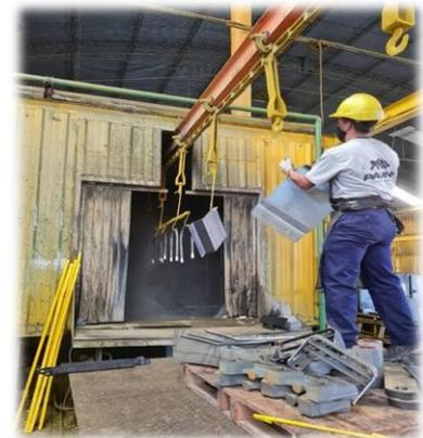
2. **Lavado y desengrase:** Consiste en eliminar grasa, polvo o impurezas que se encuentren en la superficie de la pieza. De esta manera al aplicar las debidas capas de pintura compactará de forma correcta.
