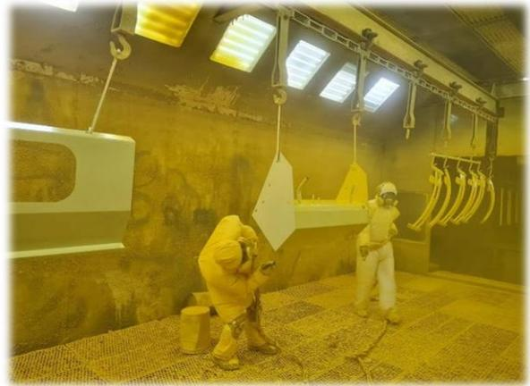
Como se observa los/las operarios/as que realizan estas tareas, cuentan con elementos de extrema seguridad, ya que están en constante contacto con el material que utilizan y los mismos no pueden ser inhalados ni estar en contacto con la piel. Esta tarea se ubica al fondo de la cadena de pintura, logrando de este modo un espacio acorde para poder realizar un trabajo correcto.
