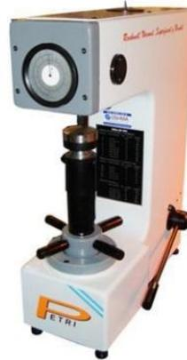
Resumidamente, el aumento de penetración expresado en micrómetros provocado por la carga adicional, determina la dureza de la pieza.
