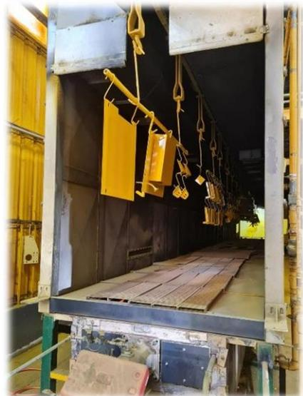
10. **Descargue de piezas:** la última etapa es la de descargar las piezas ya listas para ser enviadas al sector de montaje, para ser ensambladas donde correspondan. Todo el proceso de una carga completa de la cadena dura aproximadamente 100 minutos.
