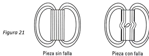
Este método, como los ensayos no destructivos, se aplica al mantenimiento en la industria aeronáutica, ferroviaria, naval, metalmecánica, entre otras.
