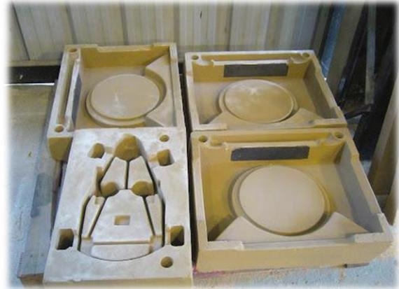
El proceso de moldeo se refiere a los métodos de fabricación del molde y a los materiales utilizados:
