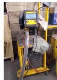
Este sistema produce una soldadura más caliente y por lo tanto permite soldar mayores espesores que la MIG.
