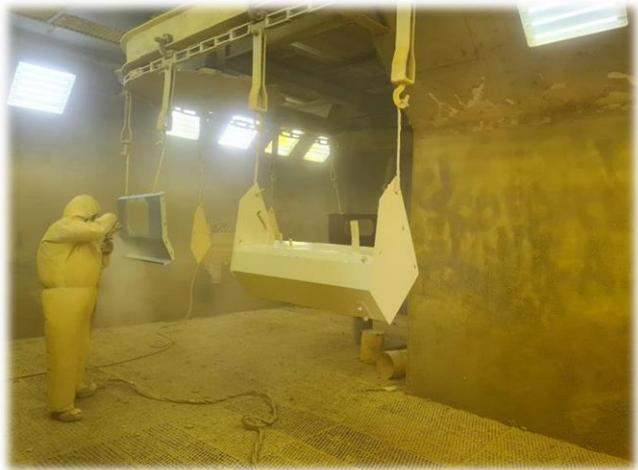
7. **Aplicación de primera mano:** para que la pintura quede correctamente se necesita que el proceso de pintado se repita en varias ocasiones, por tal motivo luego de darle el fondo se realiza la primera mano de pintura.
