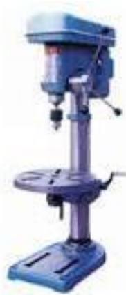
Figura 6 – Taladradora de columna (piso)
