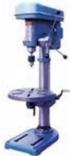
Fig. 38. Taladradora de columna (piso)
